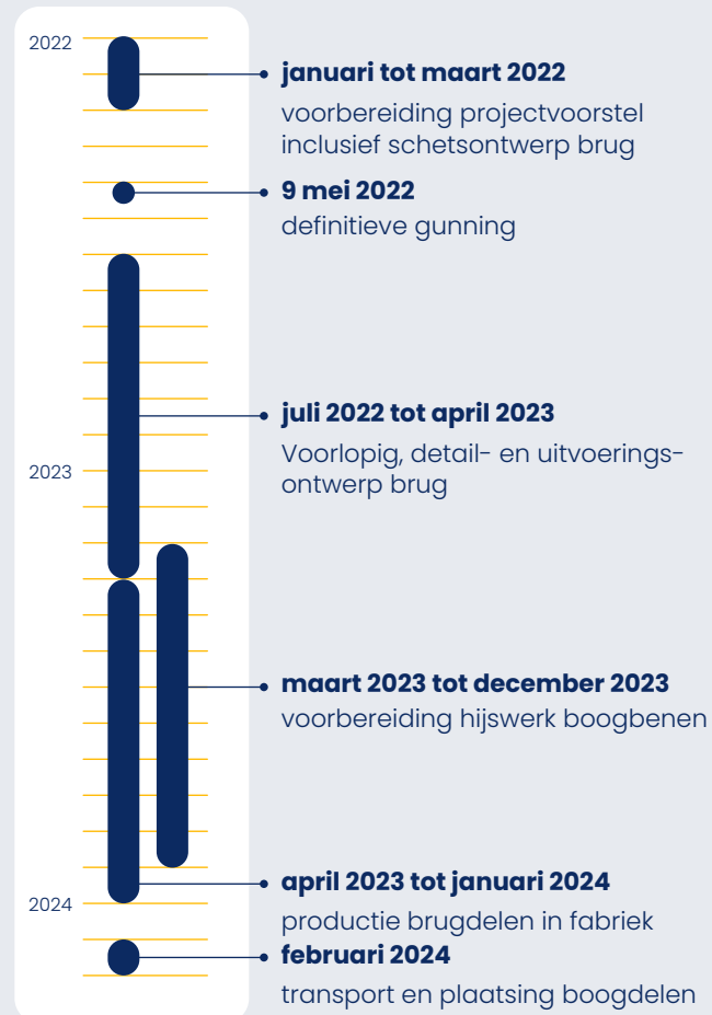
Figuur 25. Schematische weergave van fasen in de voorbereiding voor de constructie van de bogen (bron: Onderzoeksraad voor Veiligheid).
