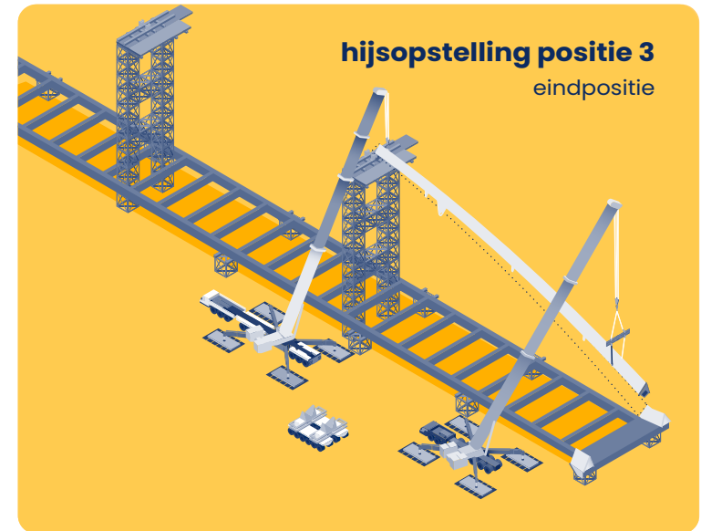
Figuur 12: Illustratie van de hijsopstelling waarbij het boogbeen boven de afzetplek op de montagetoren hing en gestart werd met het laten zakken van het boogbeen naar het brugdek. Op dat moment stonden vier personen op het montageplatform op de montagetoren (bron: Onderzoeksraad voor Veiligheid).
