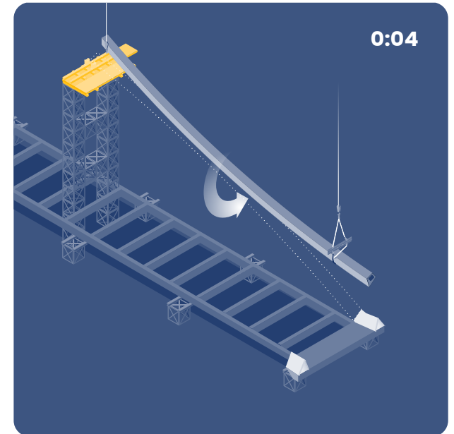
Figuur 15: Schematische weergave van het kantelen en vallen van het boogbeen met indicatie van de tijd. Het boogbeen begon met langzaam kantelen in de richting van de kranen. Binnen vijf seconden hing het boogbeen ondersteboven. Na ongeveer 6 seconden, rond het moment van terugdraaien, begon de top van het boogbeen te vallen. Het boogbeen kwam zijwaarts op het brugdek terecht en rolde er daarna deels vanaf. Ongeveer 10 seconden na de start van de kantelbeweging lag het boogbeen stil op het brugdek en de grond (bron: Onderzoeksraad voor Veiligheid).
