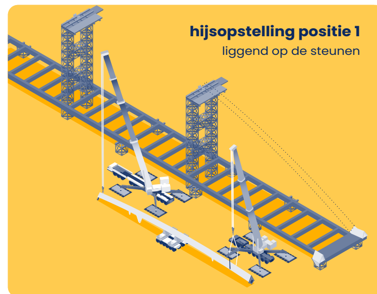
Figuur 9. Illustratie van hijsopstelling bij de start van de werkzaamheden (bron: Onderzoeksraad voor Veiligheid).
